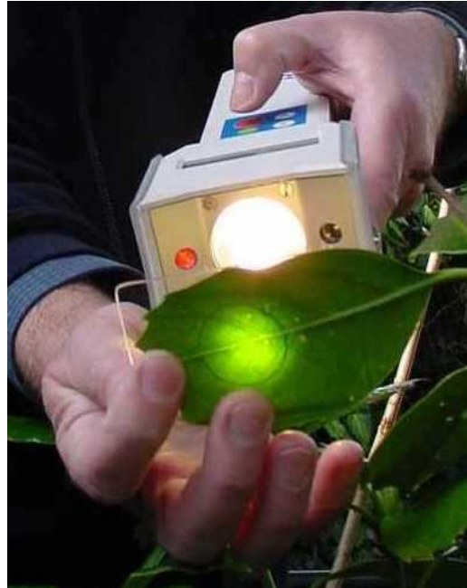
Figuur 3: De plantenfotosynthesemeter (PPM-100) met excitatielichtbron (links), verzadigingslichtbron (midden) en sensor voor meting van de fluorescentie (rechts).
