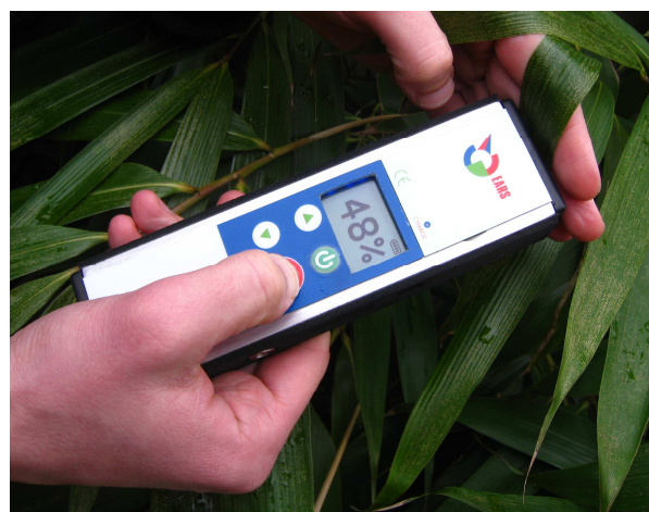
Figuur 6: Het prototype van de miniPPM . Het instrument is klein, economisch en nauwkeurig. Een druk op de knop volstaat om binnen 1 s een fotosynthesemeting te doen.
